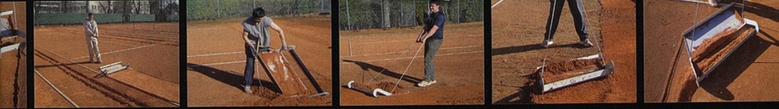
Kontrolle; dabei liegt die Gleitplatte natürlich stets vorne, auf der noch unbearbeiteten Fläche des Platzes. Linien können mit dem TM2 überfahren werden. Da das Messer einen absolut sauberen Schnitt schafft, werden die Bahnen Kante an Kante abgezogen.
